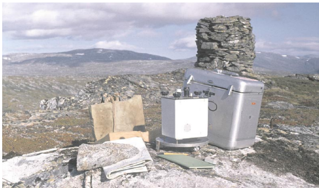
Figur 5: LaCoste & Romberg-gravimeter i felt i 1974 (foto: Bjørn Geirr Harsson).
