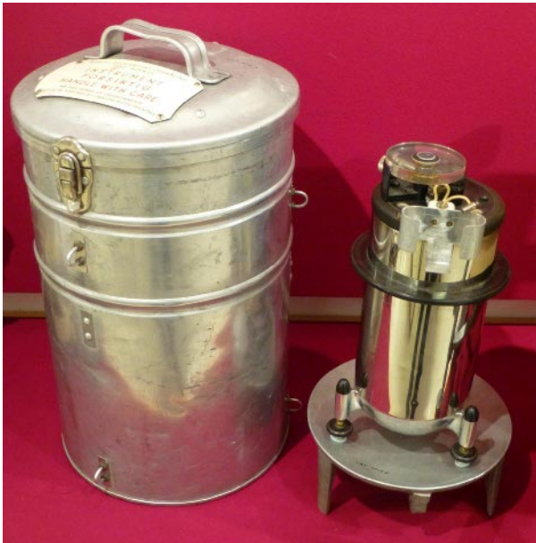
Figur 4: Worden-gravimeter med transportbeholder, fra 1953. Instrumentet er utstilt på Norsk kartmuseum i Kartverket på Hønefoss.
