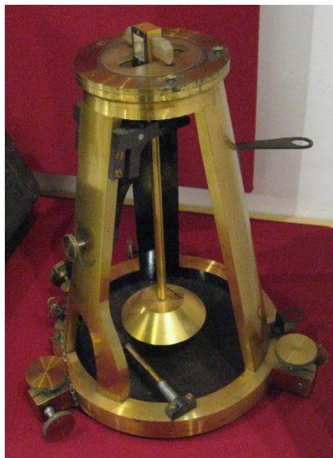
Figur 2: Gradmålingskommisjonens pendelapparat anskaffet fra Sterneck i 1892. Instrumentet er utstilt på Norsk kartmuseum i Kartverket på Hønefoss.
